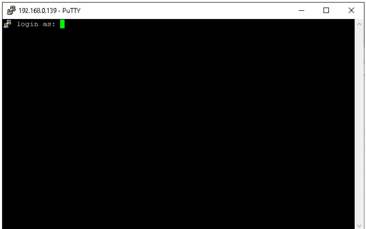
Рисунок 4 – Открытие соединения в PuTTY: ввод логина
