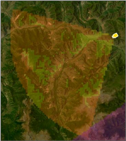
Рисунок 183 – Пример отображения видимой (желтым цветом) и невидимой (розовым цветом) области с учетом рельефа
