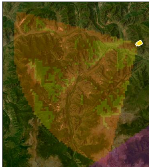
Рисунок 173 – Пример отображения видимой (желтым цветом) и невидимой (красным цветом) области с учетом рельефа
