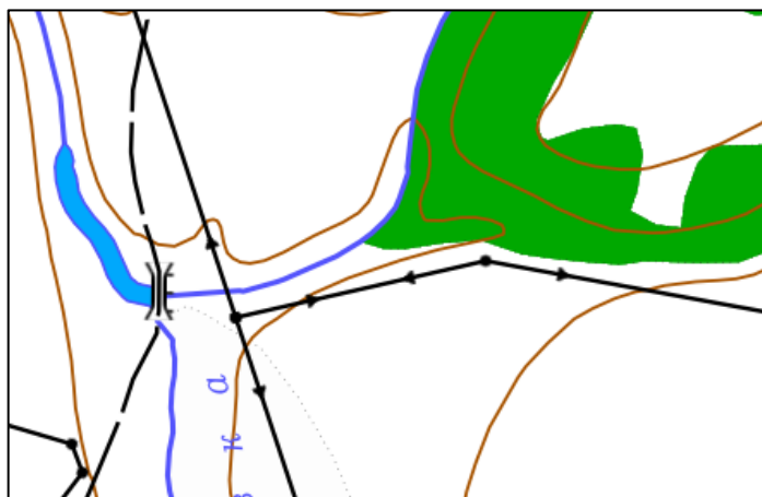
Рисунок 162 – Пример отображения ЛЭП на топографической карте
